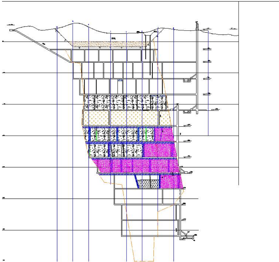
图 2.7-1 采空区充填纵投影图
